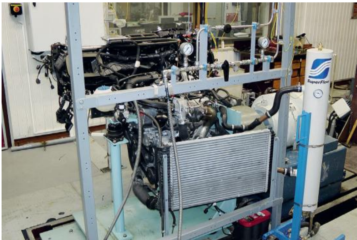
Motor vyvíjený společností MARAT Engineering na dynamometru v prostorách dílen VUT Brno. Patrná je instalace rozvodů zemního plynu (CNG) za tímto účelem do prostorů dílen.
